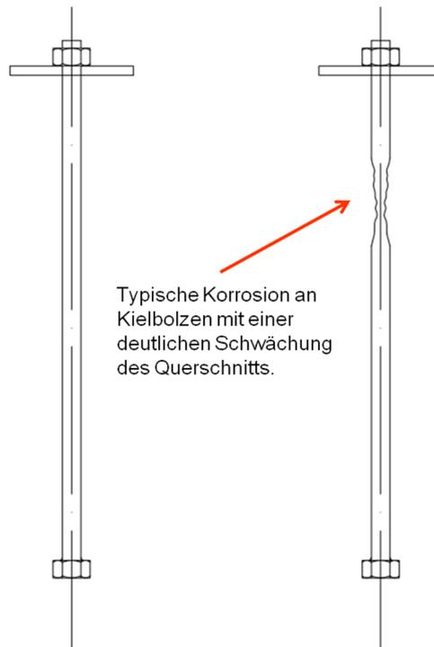
Abbildung 47: Kielbolzen Korrosion
